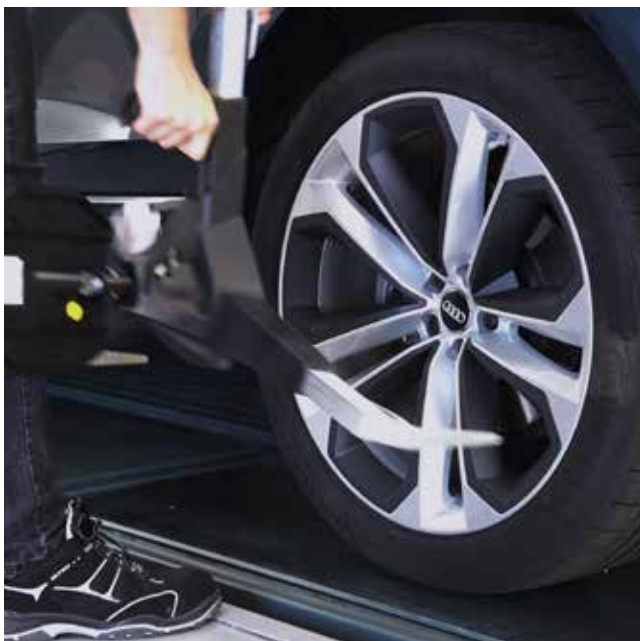
Q.Grip: Schnell und kontaktlos zur Felge montiert
