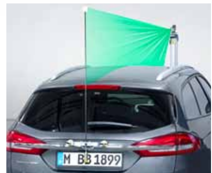
Grüner, vertikaler Laser zur symmetrischen Ausrichtung als optionales Zubehör
