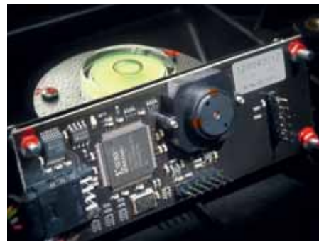
CMOS-Kamera mit hoher Auflösung und Bildrate
