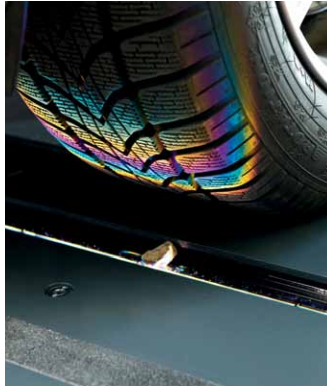
Farblichtschnittverfahren (Easy Tread) schlägt Lasersysteme bei der Neutralisierung optischer oder mechanischer Störungen im Messbereich (z.B. bei Verschmutzung durch Steine, Laub etc.)
