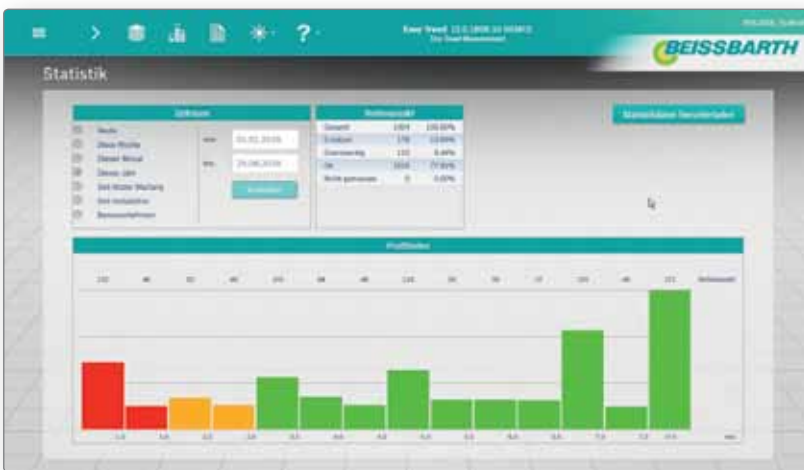
Integrierte Datenbankfunktion mit Auswertungsmöglichkeit zur Erstellung von Reifenstatistiken im Betrieb.
